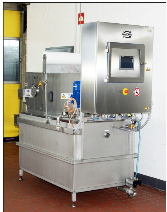
Ansicht einer Filtereinheit mit 550 Litern Brauchwasservolumen
