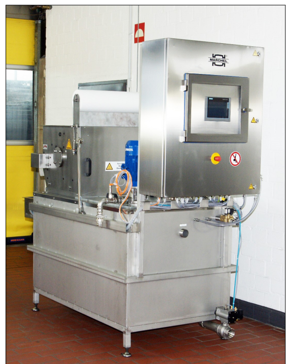
Ansicht einer Filtereinheit mit 550 Litern Brauchwasservolumen
