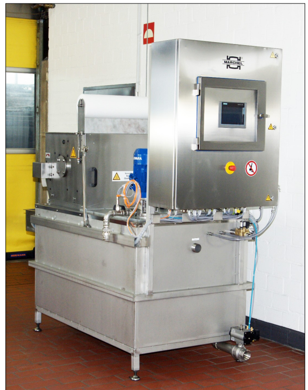
Ansicht einer Filtereinheit mit 550 Litern Brauchwasservolumen
